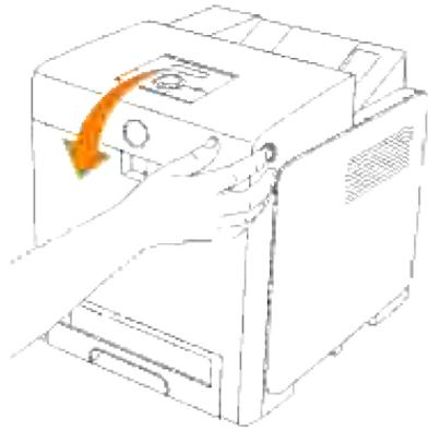
4. Tirez les leviers de dégagement et faite pivoter le module de courroie comme sur l'illustration.
